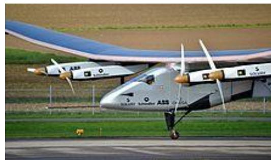
Al sinistra, un photo prise al momento del decollage in Abu Dhabi. Le aeronave HB-SIB, cognite per *Solar Impulse 2*, ha alas quasi tanto longe como un Airbus A380, ma pesa multo minus que su 500 tonnas – vermente, le avion solar pesa poco plus que un automobile!
